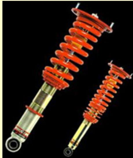
Kits mola-amortecedor integrados como esses baixam o centro de gravidade do carro e geralmente são mais rígidos do que as molas progressivas e aumentam ainda mais a resistência a rolagem. Adicionalmente, sua maior vantagem é permitir o ajuste de altura de cada extremidade do carro, o que altera as características de transferência de peso. O ajuste de altura é feito girando a engrenagem na base da mola, o que eleva ou rebaixa o suporte da mola no amortecedor.
